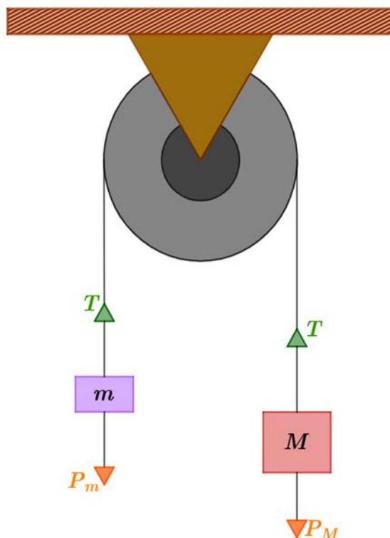
Figura 13: D.C.L. de una polea.
