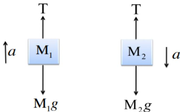
Figura 11: Diagrama de los cuerpos en una Máquina de Atwood.
