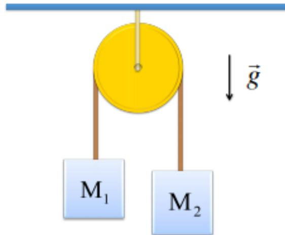
Figura 10: Diagrama de la Máquina de Atwood.
