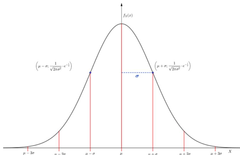
*Figura 1:* Campana de Gauss, asociada a la Distribución Normal. Se pueden apreciar los cambios de curvatura, el máximo y la desviación estándar.
