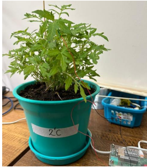
Figura 5. Montaje de spikerbox conectado a planta de tomate con electrodos, cable negro a tierra y cable rojo en peciolo.
