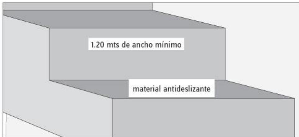
**Ilustración N°10: Características del material y del ancho mínimo de las escaleras.**
