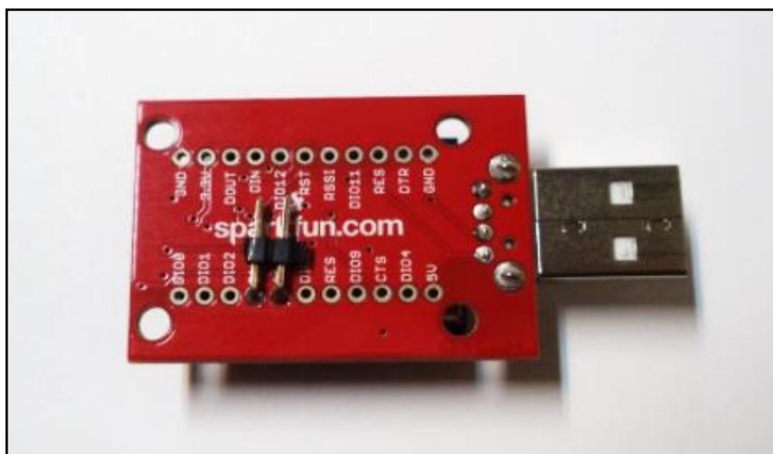
Vista posterior de la tarjeta Wireless Xbee pro 60 mW con conexión
