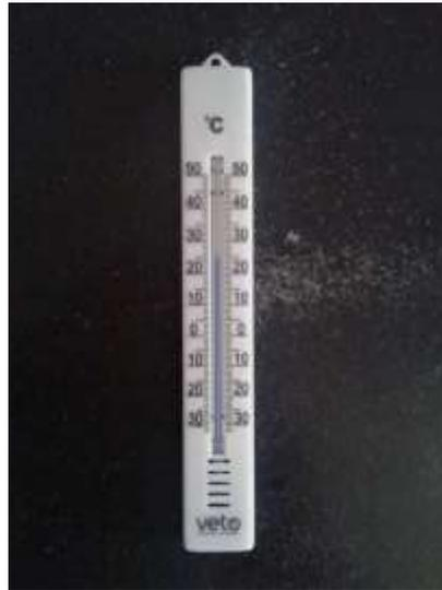
Figura 19. Termómetro ambiental, marca VETO modelo A2050000.
